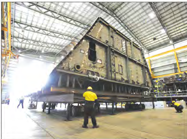
Корпусные блоки боевых кораблей, изготовленные на судостроительном предприятии «Форгакс груп»
