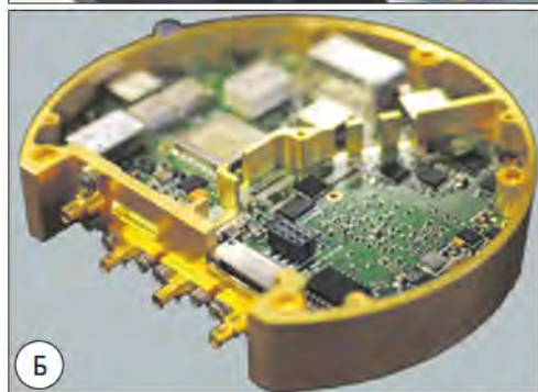
А – внешний вид противоракеты «Мхтк»; Б – электронный блок наведения; В – головка самонаведения
