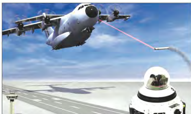
Системы защиты «Джей Мюзик» от ракет класса «земля – воздух» предполагается устанавливать на военно-транспортные самолеты А.400М
